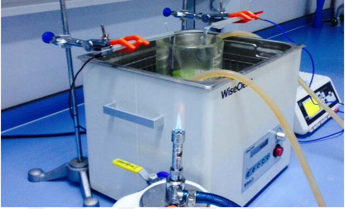
Şekil 3.2 Elektrosnikasyon işleminin ultrasonik su banyosuyla uygulanması
