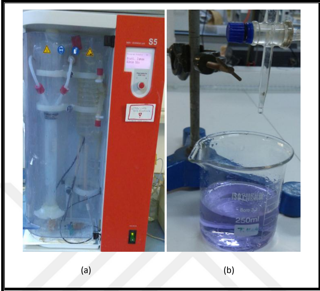
Şekil 3.2 Mikro Kjeldahl Cihazı (a), 0.1N HCl Asit İle Titre Edilmiş Örnek (b)
