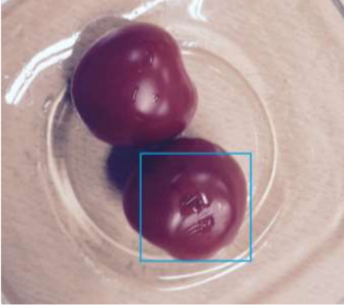
Şekil 4.7. Ultrasonik işlemcinin domateslere verdiği zararı gösteren bir resim
