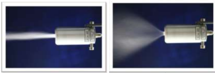
Şekil 1. (a) Titreşimli nozul olmadan partiküllerin püskürtülmesi, (b) Titreşimli nozul ile partiküllerin püskürtülmesi (Anonim, 2011)
