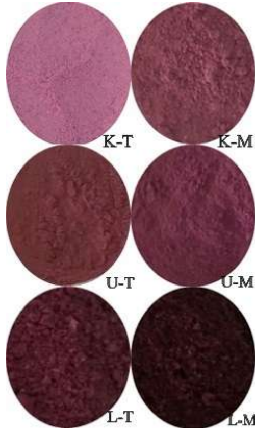
Şekil 35. Optimum noktada elde edilen püskürterek (klasik nozul, ultrasonik nozul ile) ve dondurarak kurutulan toz ve mikrokapsüllerin görüntüleri
